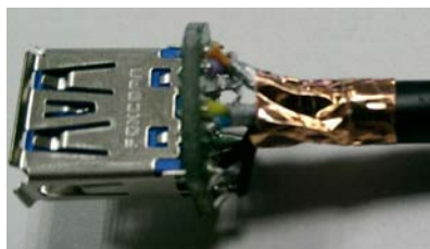
USB3.0兩對線鋁箔跟PCB板距離2~3mm 編織帶跟雙面導電銅箔導通跟PCB板距離4~5mm
