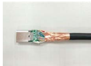
編織需跟雙面導電銅箔導通跟PCB板距離4~5mm
