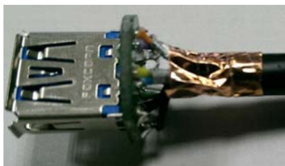
USB3.0兩對線鋁箔跟PCB板距離2~3mm 編織需跟雙面導電銅箔導通跟PCB板距離4~5mm
