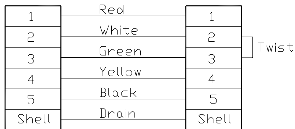
Mini USB-B Plug Wiring Diagram
